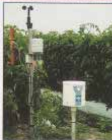
Estación en cultivo de tomate con sensores climáticos y de plagas.
